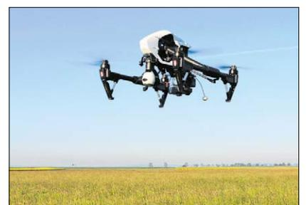
▲ Die Drohne schwebt mit einer Wärmebildkamera über dem Feld.
