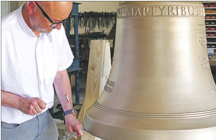
▲ Eingehende Untersuchung: Mit Präzisionsstimmgabel und Hämmerchen überprüft Pater Stefan Kling den Teiltonaufbau der neuen Friedensglocke für die Klosterkirche in St. Ottilien. Rechts hört er genau hin und stoppt, wie lange ihr Klang nachhallt. Fotos: Schwab (4)
