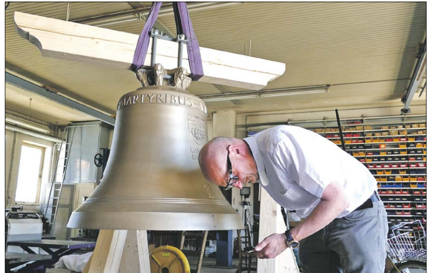
▲ Eingehende Untersuchung: Mit Präzisionsstimmgabel und Hämmerchen überprüft Pater Stefan Kling den Teiltonaufbau der neuen Friedensglocke für die Klosterkirche in St. Ottilien. Rechts hört er genau hin und stoppt, wie lange ihr Klang nachhallt. Fotos: Schwab (4)
